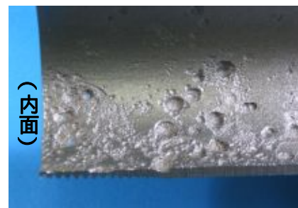
配管内部の腐食状況(酸洗い前)
